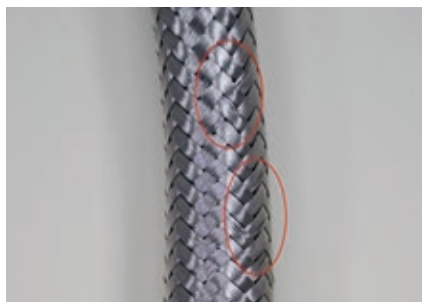
ジャケットの破損
