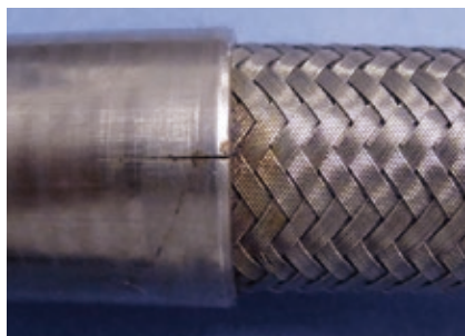
かしめ部の破損
